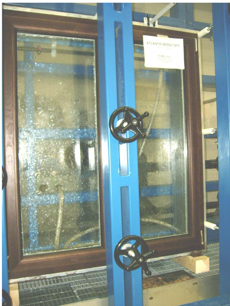
Foto 2: Campione sottoposto a prova durante la prova di tenuta all'acqua
